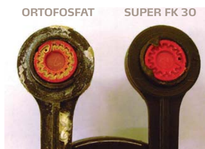
Figur 4: Drypp til venstre med ortofosfat. Drypp til høyre med Super FK 30 (polyfosfat).
